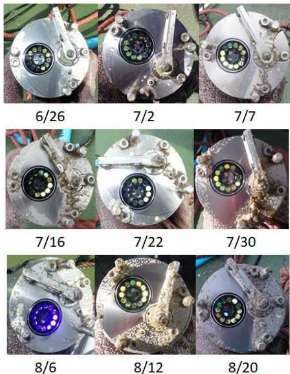
図 9 佐伯湾鶴見ポンツーンに設置したセンサーのワイパー効果
