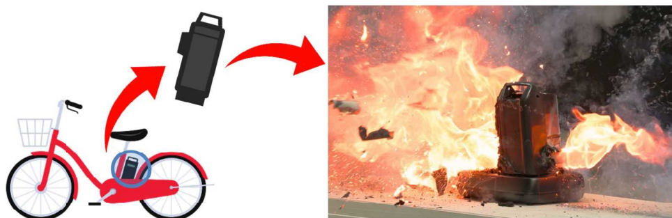
電動アシスト自転車用非純正バッテリーから発火する様子（再現イメージ） （※資料中の全ての画像は実際の事故とは関係ありません。）
