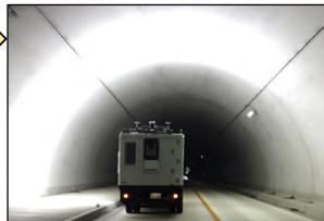
【写真→】 レーザーと高解像カメラを 搭載した専用車両による 走行型のトンネル点検
