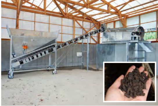
耕畜連携※により利用が広がる畜産堆肥 (散布しやすいペレット状の堆肥製造機)
