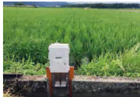
自動水門等の 現地実証による技術普及
