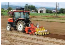
直進アシスト付き播種作業 等の委託により導入コスト を低減
