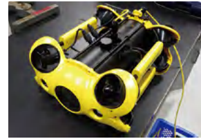
省力化に向けた水中ドローンの導入（養殖生簀の状況確認等）
