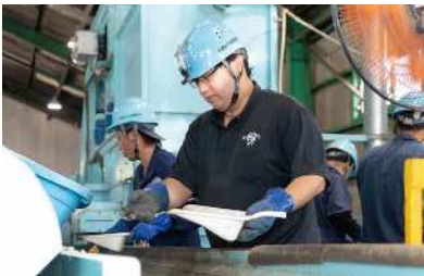
▲ピンの選別風景。瞬時にピンの色や形状、それ以外のゴミを見極め、選別します。
