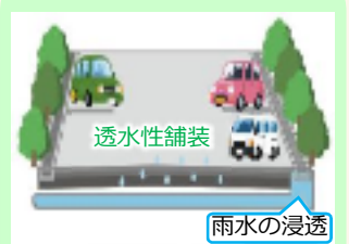
駐車場の透水性舗装による雨水の浸透
