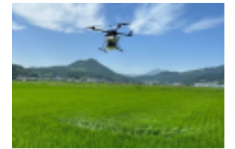
農林水産分野でも普及が進むドローン (稲への農薬散布)
