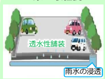
雨水の浸透 駐車場の透水性舗装による雨水の浸透
