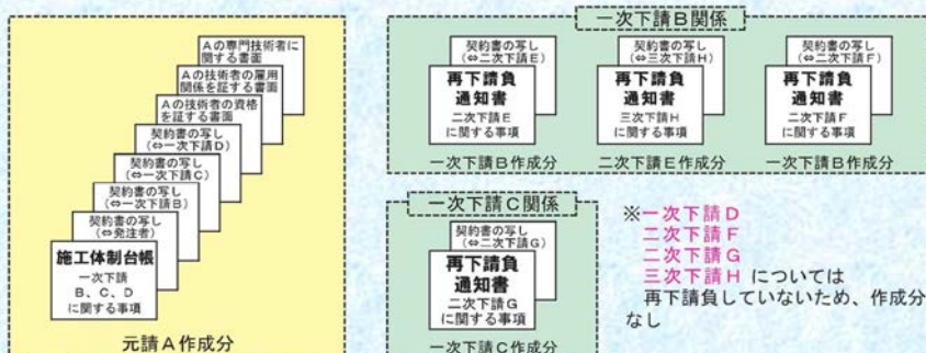
図 2-2 施工体制台帳の構成 (重要)
