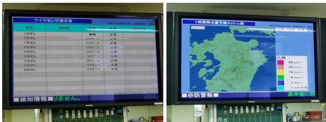
図 3.26 プラズマディスプレイ (砂防情報、検知情報、降雨情報、水位情報等を表示)
