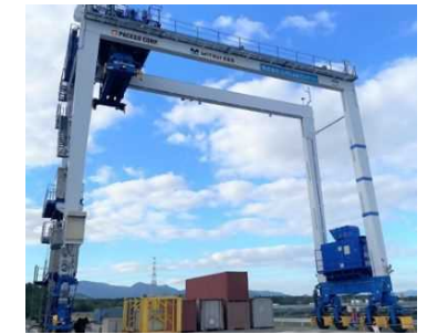
燃料電池を動力源としたクレーン (株)三井E&S
