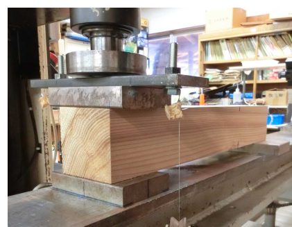
写真-1 材端部めりこみ試験
