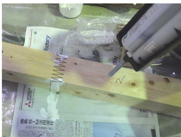
写真-2 GIR 用接着剤を充填している様子
