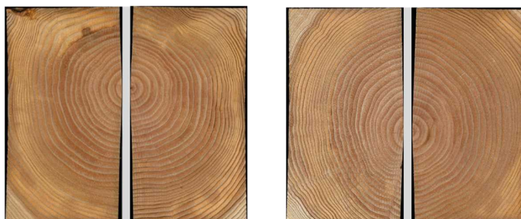
写真-3 2丁取り20の断面(養生後)
