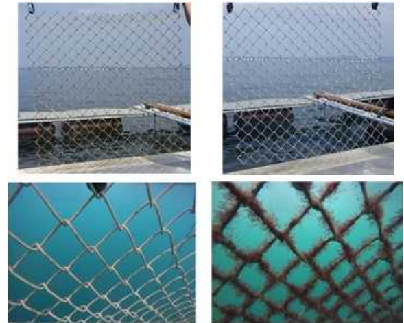
図1 テストピースを用いた付着物の付着状況 (上：試験開始前、下：設置3ヶ月後)
