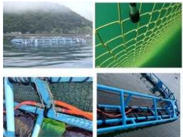
図3 銅合金製網を用いた浮沈式生簀(上左：全景、上右：生簀部分、左下：空気バルブ、右下：浮沈ブイ)
