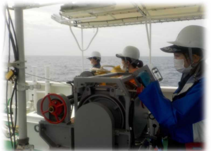
“観測用ウインチ”を使用した観測機器の昇降
