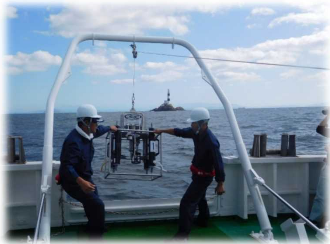
“Aフレームクレーン”を使用した観測機器の収容
