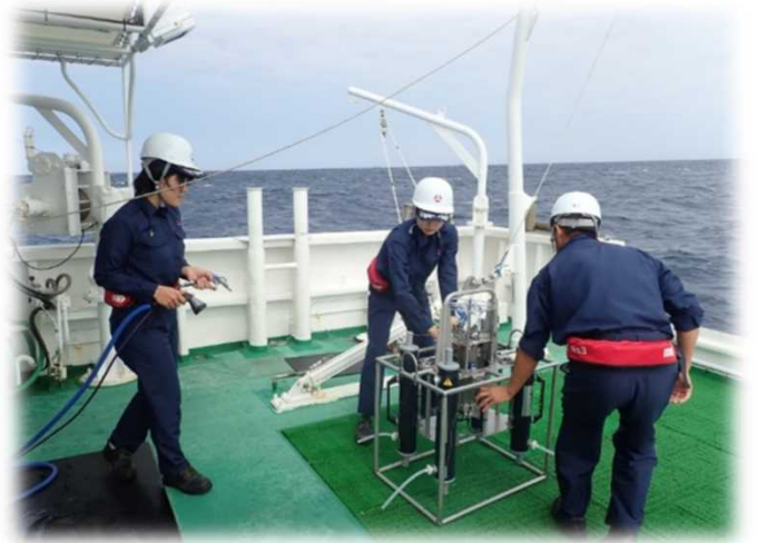
“4筒式採水装置”による水深別採水
