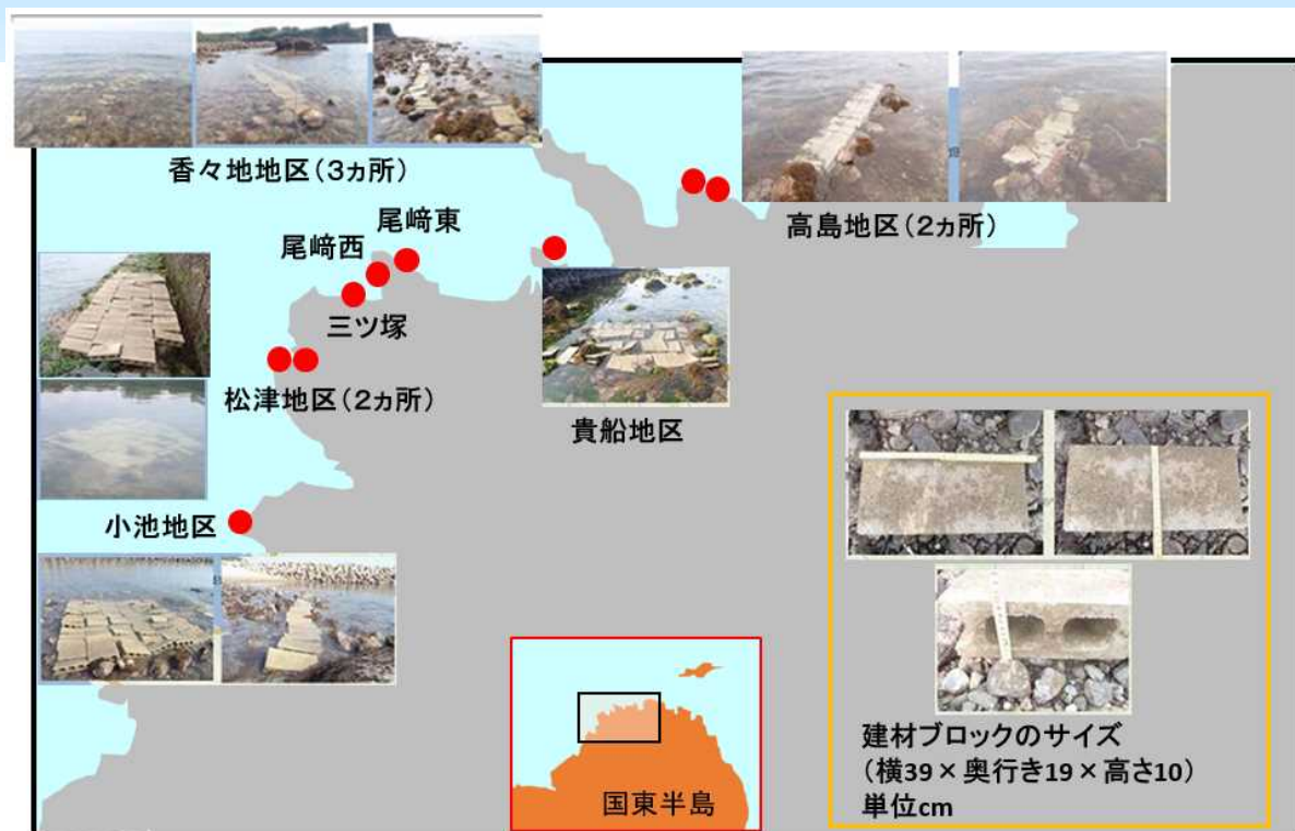
図1: 建材ブロック設置場所、状況および使用した建材ブロックのサイズ
