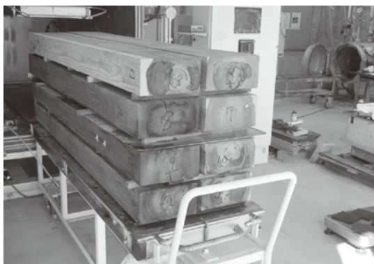
写真-3 高周波減圧乾燥材釜出しの様子
