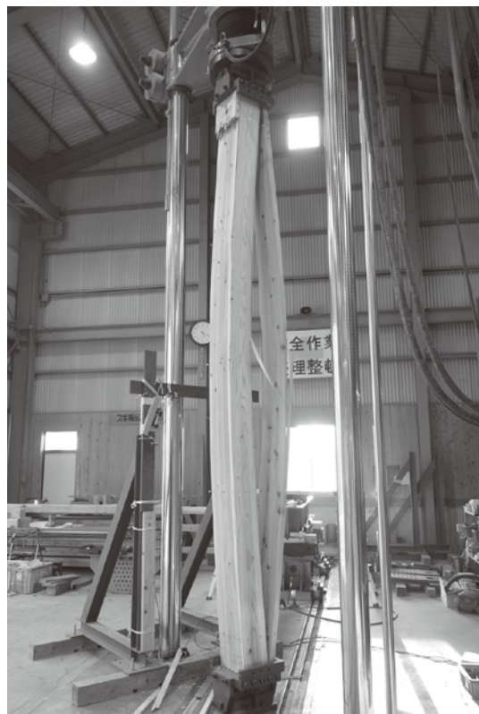
写真-5 座屈試験後の試験体の様子
