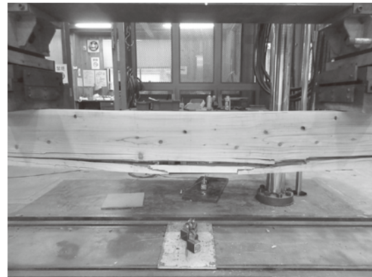
写真-4 曲げ破壊
