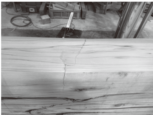
写真-5 圧縮破壊
