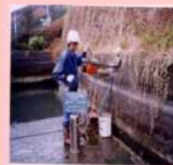
コア採取による強度測定
