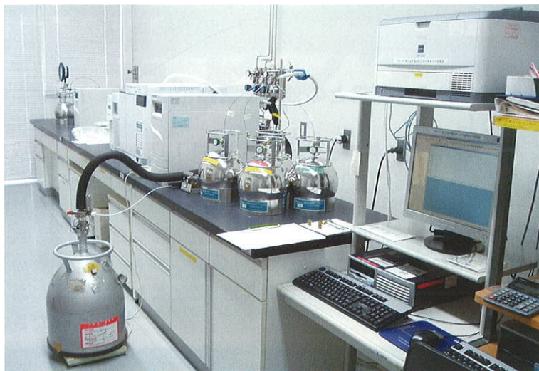
ガスクロマトグラフと質量分析装置 (大気中に含まれる微量の揮発性有機化合物濃度を測定する装置)
