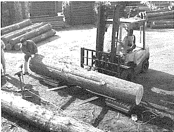
写真1 大径材の動的ヤング係数の測定
