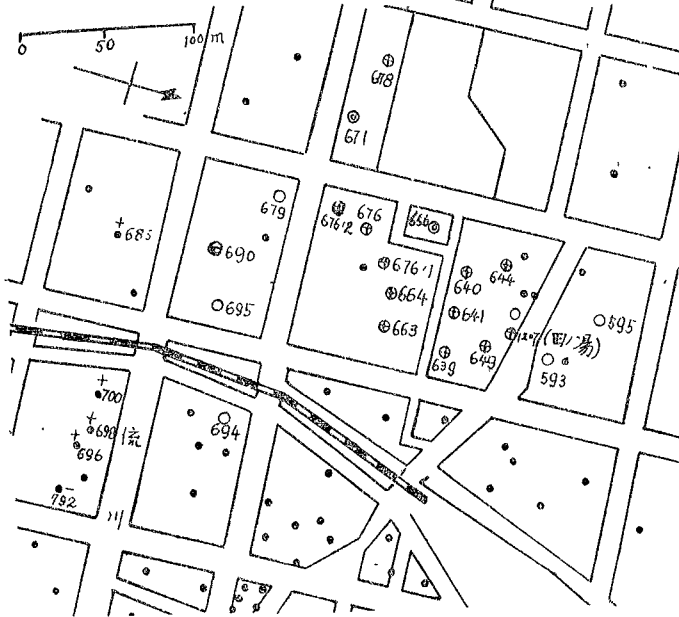
第15圖 川の湯温泉附近の温泉分布、○はポンプ揚水温泉、⊕は停電日に昇位したもの、●は自噴温泉、⊕は停電日湧出量が増したもの
