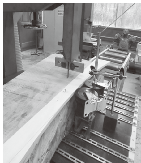
写真-2 曲線挽き製材（木端面の様子）
