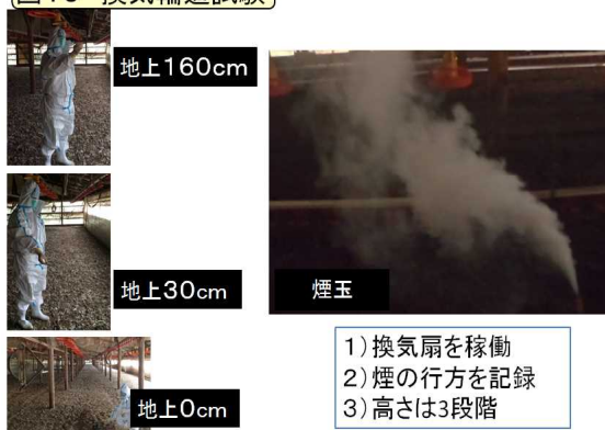
図10 換気輪道試験
